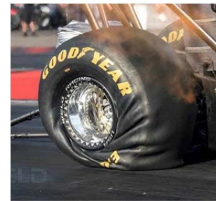
Fig. 4. Modificarea razei dinamice a roții unui dragster în timpul unui demaraj, cauzată în special de momentul motor aplicat
