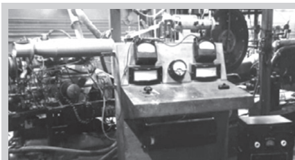
„Motorul M-207 convertit în motor cu injecție de benzină (realizarea mea în cadrul tezei de doctorat), în Laboratorul de Motoare al Institutului Politehnic Brașov (anii 1969-1970).”
