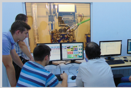
Studenți automobiliști brașoveni la pupitrul de comandă al frânei pe care se testează un motor monocilindric transparent AVL (în 2019).
