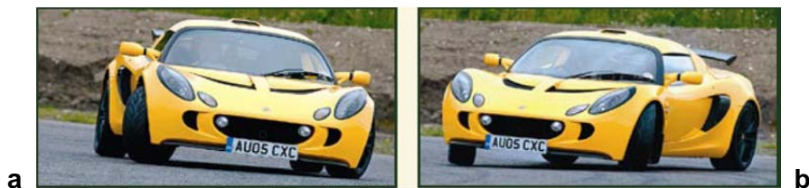
Fig. 2. Comportamente subvirator (stânga) și supravirator (dreapta) evidente
