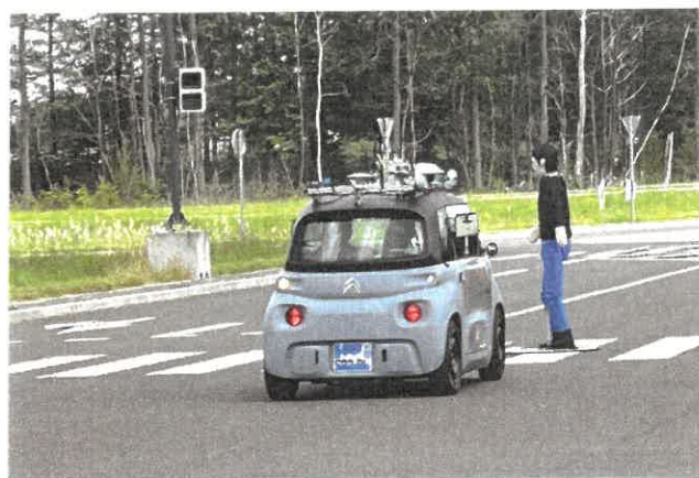
Détecter le piéton, réaliser le freinage et amener le véhicule à l'arrêt avant le passage piéton.
